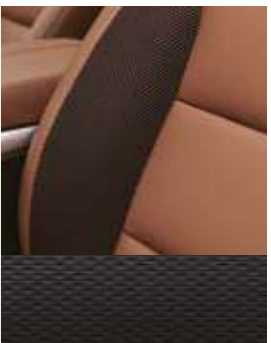
Asiento combinado de TPU y tela. Fibra ondulada en negro de alto brillo.
