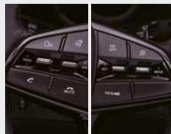
Interruptores de control remoto y sistema de control de cruceo en el volante
