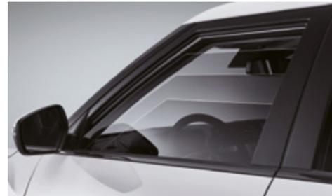
Ventanillas eléctricas (delanteras de un solo toque)
