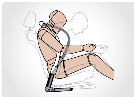
Cinturones de seguridad con doble pretensor y limitador de esfuerzo
