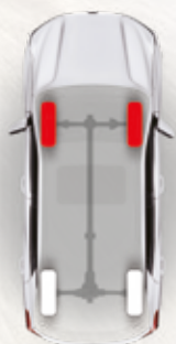
Tracción 2WD Condiciones normales de carretera (tracción delantera).
