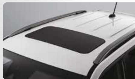
Techo solar y rieles lacados
