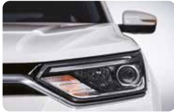
Faros de proyección con luces diurnas LED
