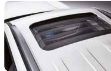
Techo solar eléctrico
