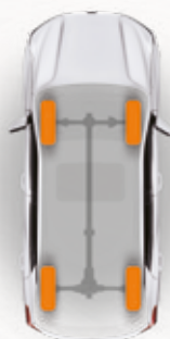
Modo 4WD LOCK Utilízalo cuando necesites máxima adherencia al terreno (bloqueo del diferencial central).
