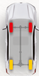
Tracción 4WD En caso de necesitar mayor tracción, como en carreteras sin asfaltar o con nieve, el sistema entrega par al eje trasero (tracción total).
