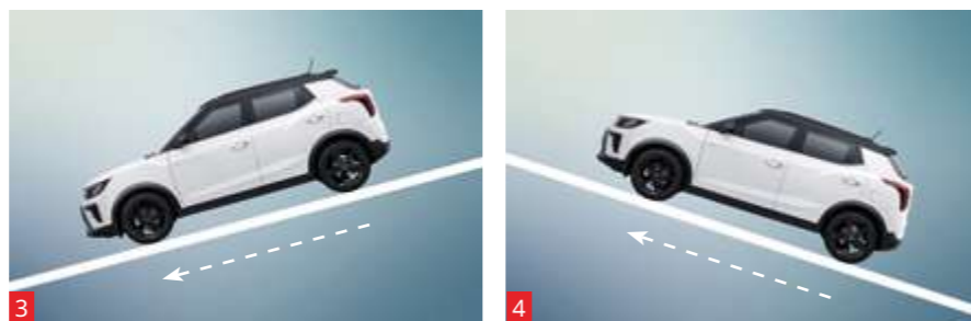
1 Sistema activo antivuelco (ARP) 2 Aviso luminoso de frenada de emergencia (ESS) 3 Control de descenso en pendientes (HDC) 4 Asistente de arranque en pendientes (HSA)
