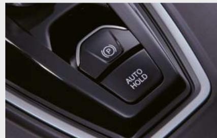
Freno electrónico de estacionamiento (EPB)
