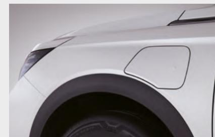
Conector de carga en aleta delantera
