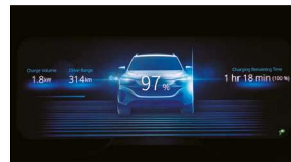
Indicador del estado de carga de la batería (SOC)
