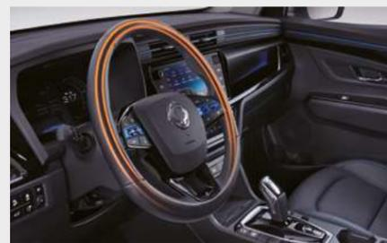
Volante calefactado, inclinable y telescópico
