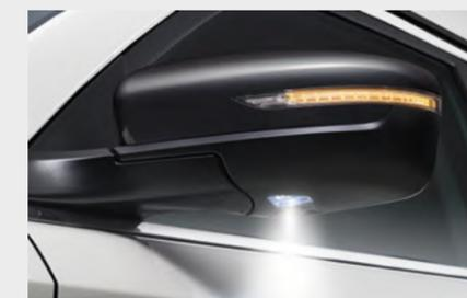
Retrovisores con intermitente LED integrado y luz de cortesía
