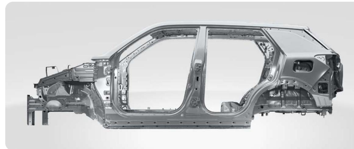
La estructura del Korando está fabricada con un 74% de acero de alta resistencia para asegurar una rigidez y seguridad perfectas. Este material se complementa con tecnología NVH de reducción de ruidos que garantiza un nivel de 44 dB.
